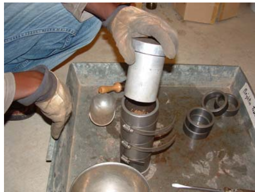
(d) Placing compaction piston
