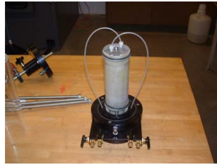
(d) Placing the top cap
